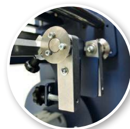
Rimozione del bordo della bobina in eccesso
